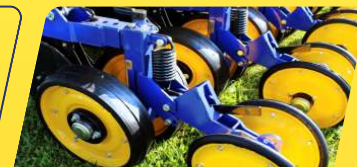
REGULAGEM PARA AFASTAMENTO DA RODA COMPACTADORA
