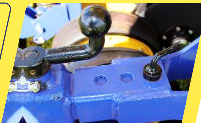
REGULAGEM PARA AFASTAMENTO DA RODA COMPACTADORA
