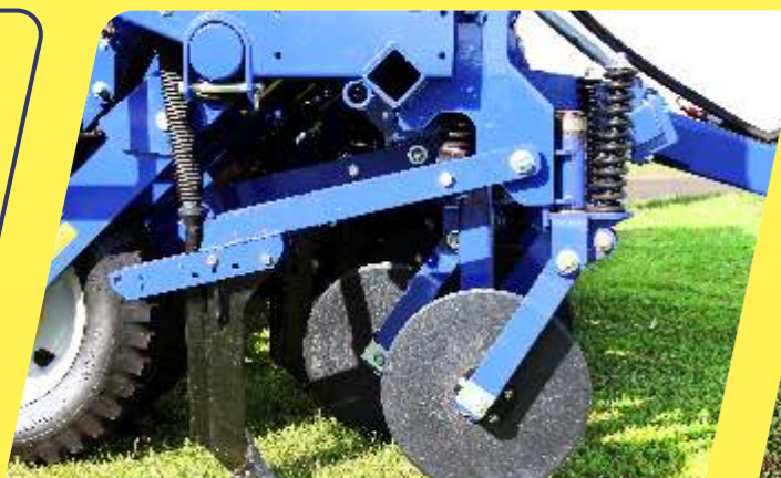
DISCOS DE CORTE DESALINHADOS E SULCADOR FACÃO AFASTADO NO ADUBO
